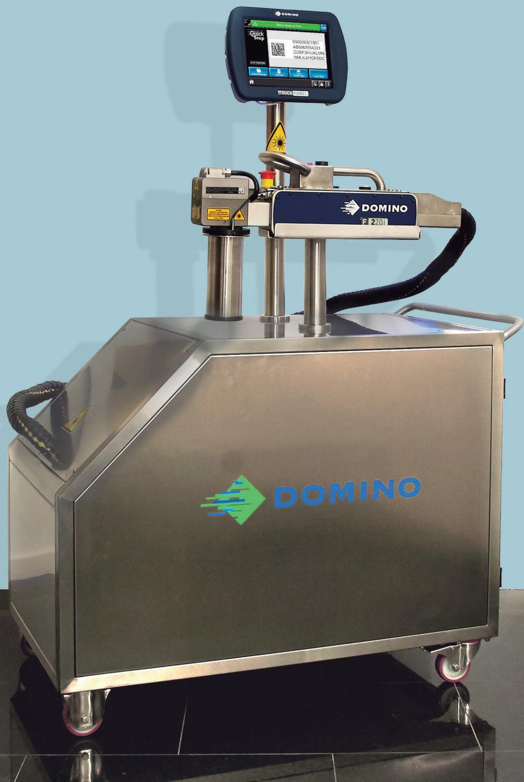
Atentos às necessidades dos nossos clientes, desenvolvemos uma estrutura integradora do sistema laser de fibra Domino F220i que lhe permite uma codificação segura e eficiente nas superfícies de acesso difícil.
